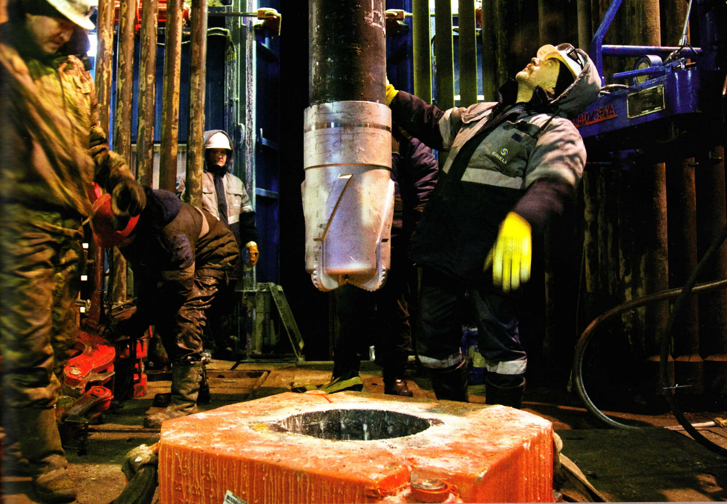
50 000 eiro maksā tikai dimantiem aprīkotā urbja galviņa, kuru strādnieki pieregulē "Novij Urengoļ" – zemes gāzes centrā
